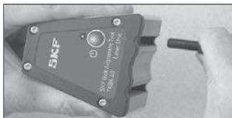
Fig 2 Montaggio o smontaggio delle guide a V
